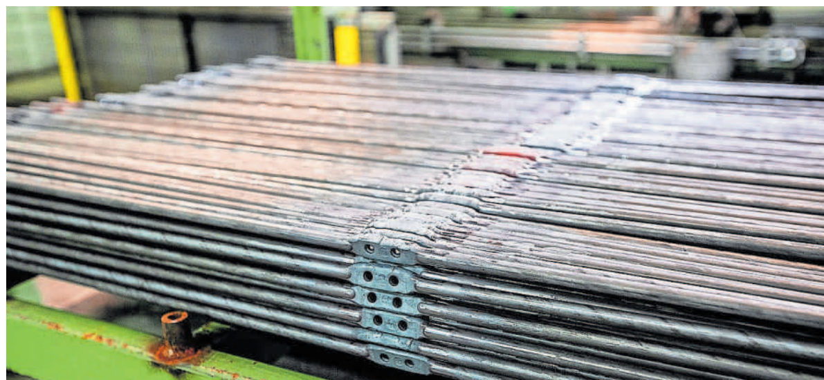
Deze metalen staven voor de zeefbanden worden bewerkt wanneer ze door inductie gloeiend heet zijn gemaakt.
